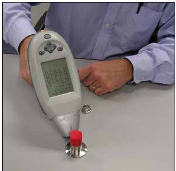
Prueba de identidad de la aleación
