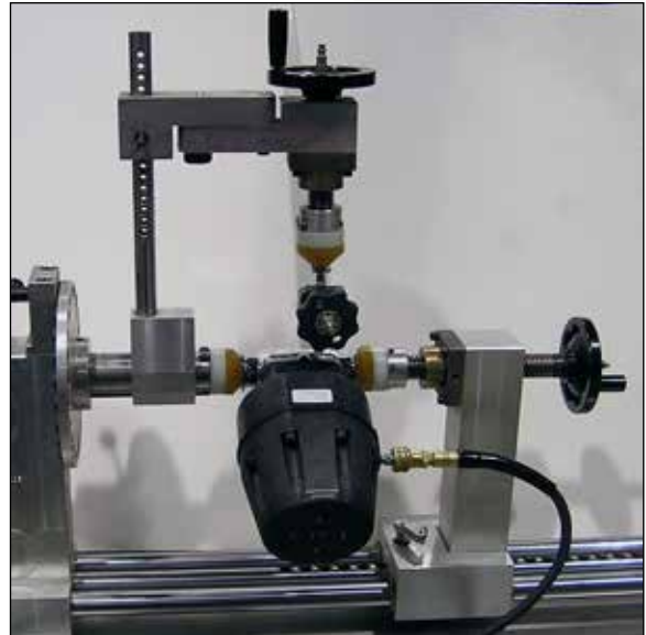
Prueba de la caja y fugas
