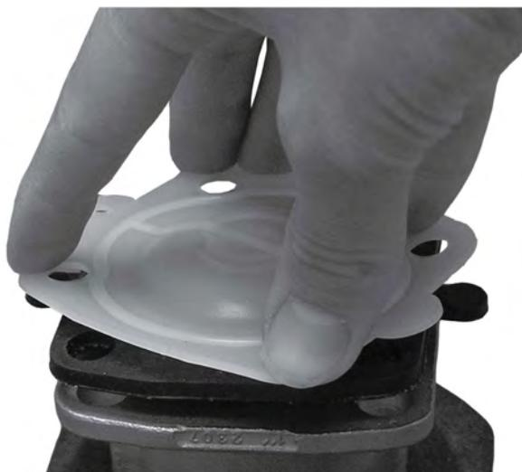
9. Retorne (não mais do que uma volta) até os orifícios dos parafusos no diafragma e na manilha do tampo ficarem alinhados.
