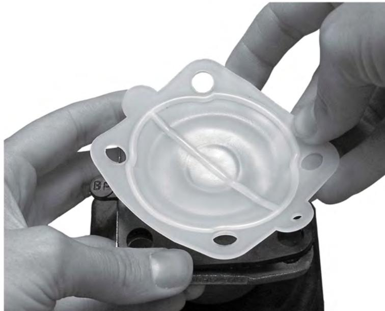
7. Gire o diafragma até ser alcançada a parada rígida ou a resistência pesada e força adicional não gira significativamente o diafragma para o compressor.
