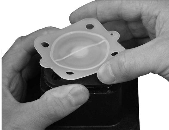
3. Ruotare il diaframma fino a quando non si raggiunge un fermo o una notevole resistenza e un'ulteriore forza non consente di ruotare significativamente il diaframma nel compressore.
