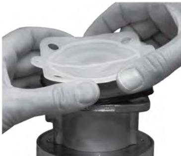
4. Ruotare il diaframma fino a quando non si raggiunge un fermo o una notevole resistenza e un'ulteriore forza non consente di ruotare significativamente il diaframma nel compressore.
