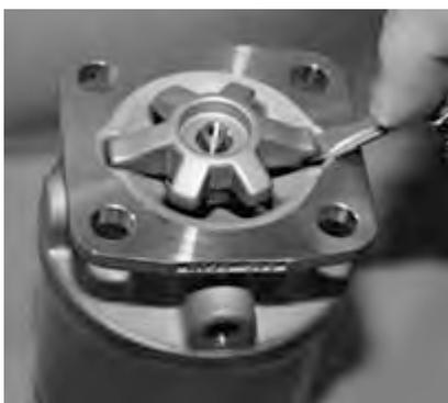
**Figura 8: Rimuovere il compressore**
