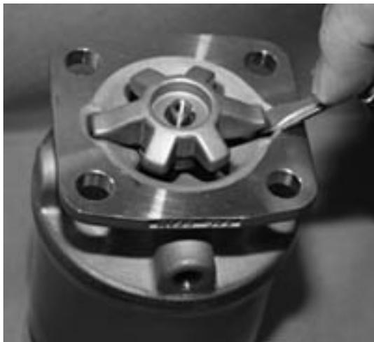
**Abbildungsnummer 6: Entfernen Sie die Druckbaugruppe**
