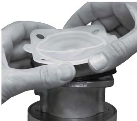
4. Die Membran bis zum Anschlag oder zu einem starken Widerstand drehen, so dass sie durch weiteren Kraftaufwand nicht mehr wesentlich weiter in die Druckbaugruppe eingeschraubt wird.
