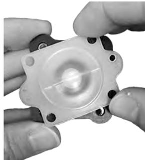
4. Visser la membrane jusqu'à la butée ou à une forte résistance, où une force supplémentaire ne fait plus pivoter notablement la membrane par rapport au compresseur.
