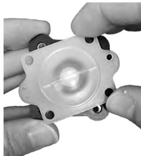
4. Ruotare il diaframma fino a quando non si raggiunge un fermo o una notevole resistenza e un'ulteriore forza non consente di ruotare significativamente il diaframma nel compressore.
