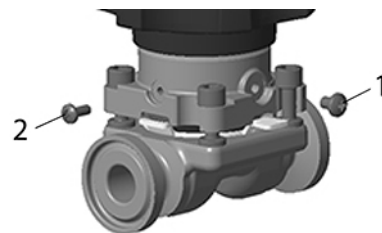
Abbildungsnummer 11: BioviZion/PFuZion 0,5 Zoll mit abgedichteter Ventildeckelschraube und Druckringhaltung
