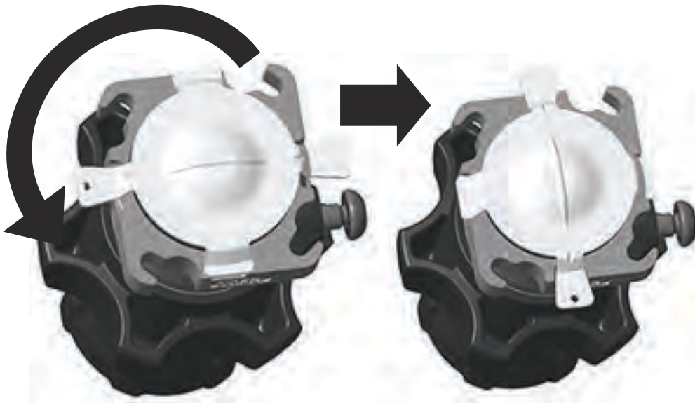
Figura 27: Installazione del diaframma
