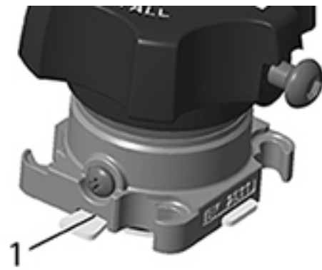
Figura 19: Montaggio corpo-cofano - Potenziali punti di schiacciamento
