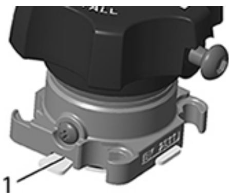
Рис. 19: Крепление крышки к корпусу — места возможного зацебления
