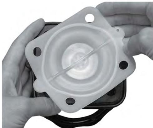
4. Drehen Sie die Membran so lange, bis ein harter Anschlag oder ein starker Widerstand erreicht ist und weiterer Kraftaufwand die Membran nicht mehr wesentlich weiter in die Druckbaugruppe einschraubt.
