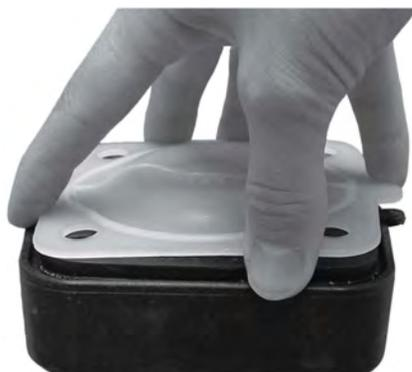
7. Das Handrad so weit gegen den Uhrzeigersinn drehen, dass die Flanschfläche der Membran auf der Flanschfläche des Ventildeckels aufliegt.
