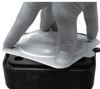
6. Drehen Sie die Membran zurück (maximal eine halbe Umdrehung) bis die Schraubenlöcher von Membran und Ventildeckelflansch übereinander liegen.
