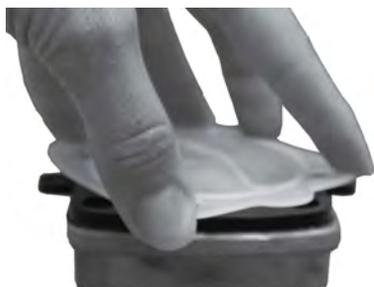
6. Drehen Sie die Membran zurück (maximal eine halbe Umdrehung) bis die Schraubenlöcher von Membran und Ventildeckelflansch übereinander liegen.
