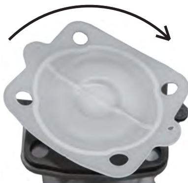
5. Durante la sostituzione di un diaframma in PTFE, reinvertire il diaframma.
