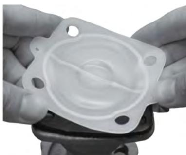
4. Ruotare il diaframma fino a quando non si raggiunge un fermo o una notevole resistenza e un'ulteriore forza non consente di ruotare significativamente il diaframma nel compressore.
