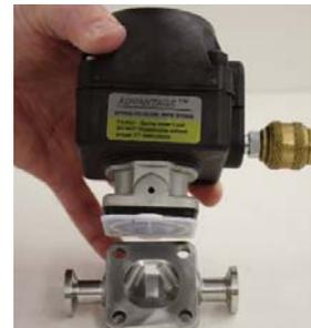
9. Toujours avec l'actuateur à mi-course, monter le corps de la vanne avec l'actuateur avec les vis. (à la main sans l'emploi d'outils).
