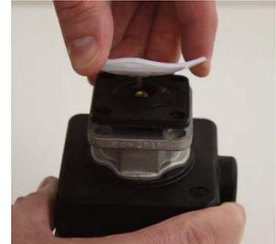
7. Revenez en arrière (pas plus d'un 1/2 tour) jusqu'à l'alignement des trous de vis de la membrane et de la bride de l'actuateur.
