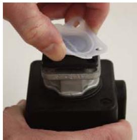
6. Installation de la nouvelle membrane. Engagez la vis de la membrane dans le filetage de l'axe de l'actuateur en la faisant pivoter dans le sens horaire. Vissez la membrane jusqu'à la butée sans forcer la position par rapport aux trous de fixation et dépassez légèrement l'alignement. (Pour plus de détails, regarder la feuille technique pour l'installation de membranes).
