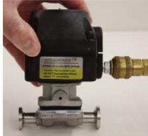
3. Démontez les vis de fixation entre l'actuateur et le corps de la vanne.
