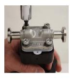
6. Revenez en arrière (pas plus d'un 1/2 tour) jusqu'à l'alignement des trous de vis de la membrane et de la bride de l'actuateur.
