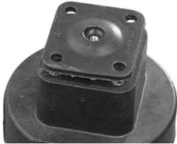
3.7.4.2 Inversez la membrane en pressant sur son centre avec le pouce tout en la retenant par le bord avec les doigts.
