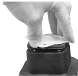
3.7.7 Revenez en arrière (pas plus d'un 1/2 tour) de façon à ce que les trous de boulon de la membrane et de la bride du chapeau soient alignés.
