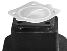
3.7.4.4 Continuez à faire tourner la membrane dans le sens des aiguilles d'une montre pour la visser dans le compresseur tout en empêchant la rotation du coussinet.
