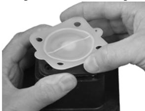
3.7.5 Vissez la membrane jusqu'à ce qu'elle vienne en butée ou qu'une résistance élevée se manifeste, empêchant la membrane de tourner dans le compresseur lorsqu'on augmente la force exercée sur celle-ci.
