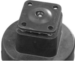
3.7.4.2 Stülpen Sie die PTFE-Membran um, indem Sie mit den Daumen auf die Mitte der Membranoberfläche drücken, während Sie die Membran am Rand mit den Fingern halten.
