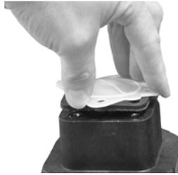
3.7.7 Drehen Sie die Membran heraus (maximal eine halbe Umdrehung), bis die Schraubenlöcher in der Membran und im Ventildeckelflansch miteinander ausgerichtet sind.
