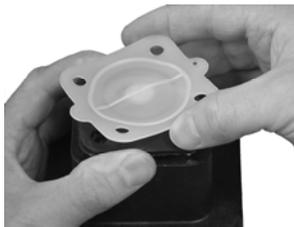
3.7.5 Drehen Sie die Membran bis zum Anschlag oder bis diese schwergängig wird und sich auch durch zusätzlich aufgewendete Kraft nicht weiter in die Druckbaugruppe drehen lässt.
