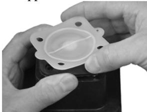
3.7.5 Avvitare il diaframma finché si blocca o si incontra una notevole resistenza e una forza aggiuntiva non consente di ruotare in modo significativo il diaframma nel compressore.
