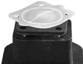
3.7.4.4 Continuare ad avvitare il diaframma PTFE in senso orario nel compressore tenendo fermo il cuscinio di supporto.
